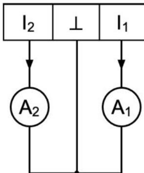
Рис.11. Подключение вторичных приборов к токовым выходам.
